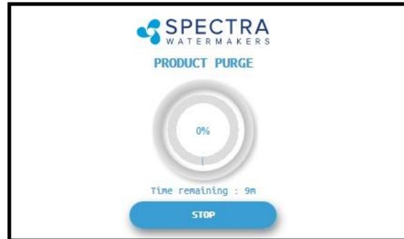
12. Una vez que se completa el ciclo de purga de agua tratada, el sistema le pedirá que reinicie y, luego, avanzará al menú principal. Si se trata de una INSTALACIÓN NUEVA, continúe con las instrucciones de calibración para finalizar la instalación. Si está volviendo a poner en servicio la desalinizadora después de almacenarla o limpiarla, su sistema ya está listo para ser utilizado.
