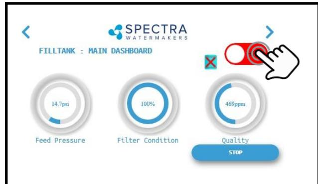
**Nota:** El sistema pasará automáticamente al modo *Low* cuando detecte una presión de membrana alta o una presión de refuerzo (de alimentación) baja.
