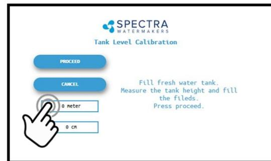
Presione el campo de pies (*meter* o metros) para ingresar la altura del tanque en pies (metros).
