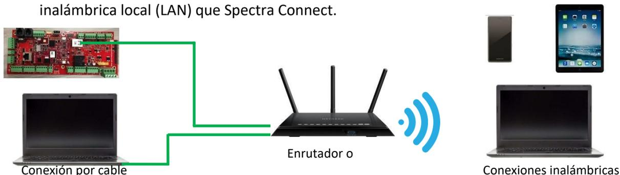
7. En la computadora, tableta o teléfono inteligente, abra un navegador web, como Firefox, Chrome o Safari. En la barra de dirección web ubicada en la parte superior, escriba la dirección 'IP del dispositivo' registrada con anterioridad. Presione *Enter* (entrar).
