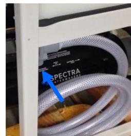
6. Mueva el interruptor de palanca de velocidad de servicio a la posición *ON* (encendido) y la caja de control a *Service* (servicio) para encender la bomba y haga circular el producto químico de almacenamiento en el sistema durante, al menos, 20 minutos. Mueva el interruptor de velocidad de servicio a la posición *OFF* (apagado).
